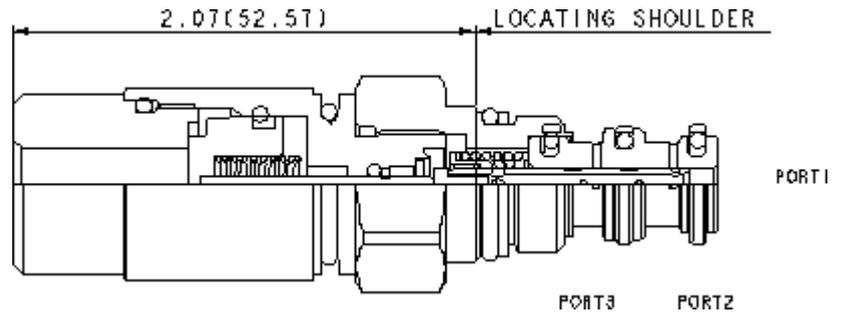
Dieses pneumatisch betätigte 3/2-Wege Vorsteuerventil mit Federrückstellung ist in zwei Schieberausführungen erhältlich: In Ruhestellung geöffnet von 1 nach 2 und in Ruhestellung geöffnet von 1 nach 3. Das Ventil eignet sich nur für kleine Volumenströme.
