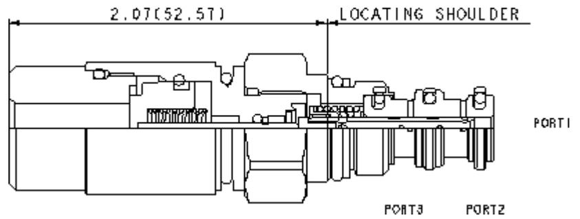
Dieses pneumatisch betätigte 3/2-Wege Vorsteuerventil mit Federrückstellung ist in zwei Schieberausführungen erhältlich: In Ruhestellung geöffnet von 1 nach 2 und in Ruhestellung geöffnet von 1 nach 3. Das Ventil eignet sich nur für kleine Volumenströme.
