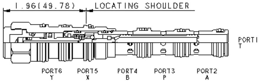
4/2-Wegeventil, hydraulisch betätigt, mit Raste und 6 Anschlüssen. 3 unterschiedliche Schieberversionen stehen zur Auswahl. Der Zulauf ist an Anschluss 3. Alle Anschlüsse können mit 350 bar belastet werden. Die maximale Durchflussmenge ist abhängig von der gewählten Schieberversion.
