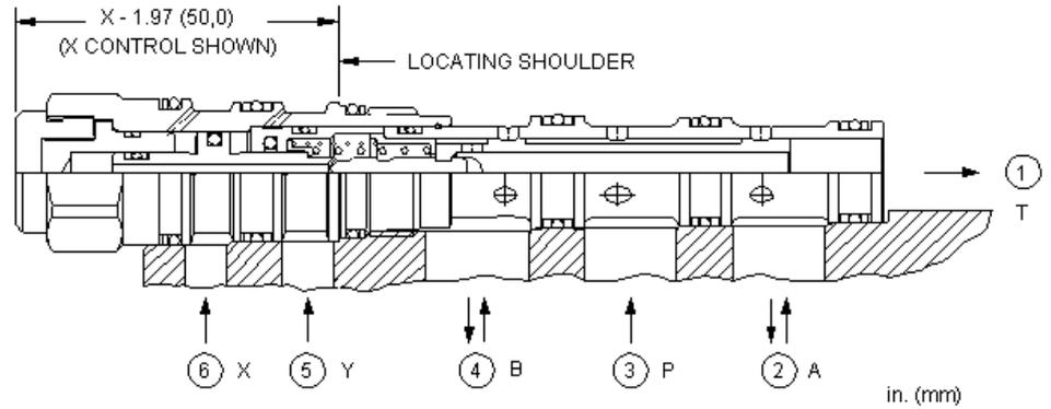
4/2-Wegeventil, hydraulisch betätigt, Federrückstellung, mit 6 Anschlüssen. 9 unterschiedliche Schieberversionen stehen zur Auswahl. Der Zulauf ist an Anschluss 3. Alle Anschlüsse können mit 350 bar belastet werden. Die maximale Durchflussmenge ist abhängig von der gewählten Schieberversion.
