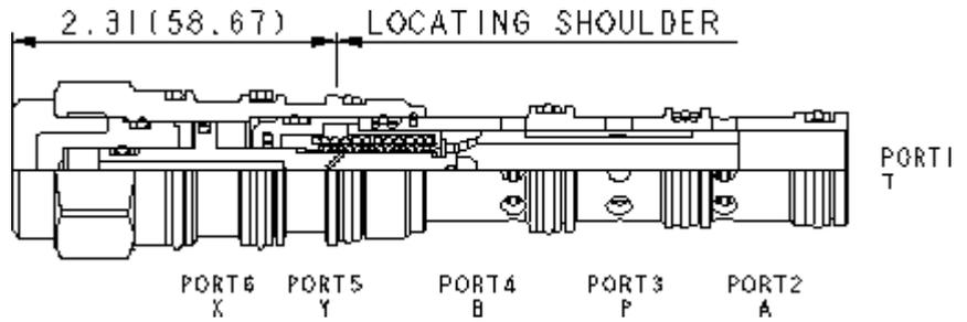
4/3-Wegeventil, hydraulisch betätigt, federzentriert, mit 6 Anschlüssen. Die Konfiguration hängt von der Wahl der Schieberversion ab. Der Zulauf ist an Anschluss 3. Alle Anschlüsse können mit 350 bar belastet werden. Die maximale Durchflussmenge ist abhängig von der gewählten Schieberversion.
