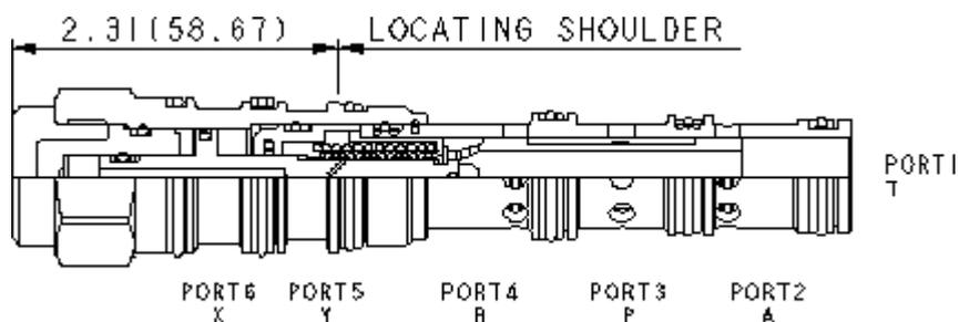
Les distributeurs en cartouches à 4 voies et 3 positions, centrés par des ressorts, sont des valves directionnelles à 6 orifices, qui offrent un choix de différentes configurations de tiroir. L'orifice d'alimentation est l'orifice 3 et tous les orifices acceptent 350 bar (5000 psi). La capacité en débit de ces valves à commutation par pilotage hydraulique dépend du type de tiroir choisi.
