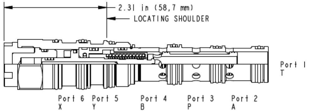
Les distributeurs en cartouches à 4 voies et 2 positions sont des valves directionnelles à 6 orifices qui offrent un choix de 9 configurations différentes de tiroir. L'orifice d'alimentation est l'orifice 3 et tous les orifices acceptent une pression de 350 bar (5000 psi). La capacité en débit de ces valves à commutation par pilotage hydraulique dépend du type de tiroir choisi.
