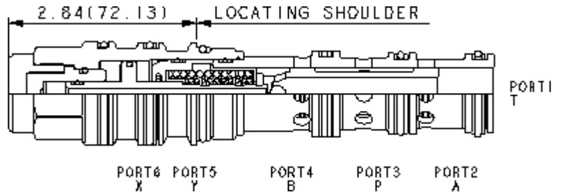
4/3-Wegeventil, hydraulisch betätigt, federzentriert, mit 6 Anschlüssen. Die Konfiguration hängt von der Wahl der Schieberversion ab. Der Zulauf ist an Anschluss 3. Alle Anschlüsse können mit 350 bar belastet werden. Die maximale Durchflussmenge ist abhängig von der gewählten Schieberversion.
