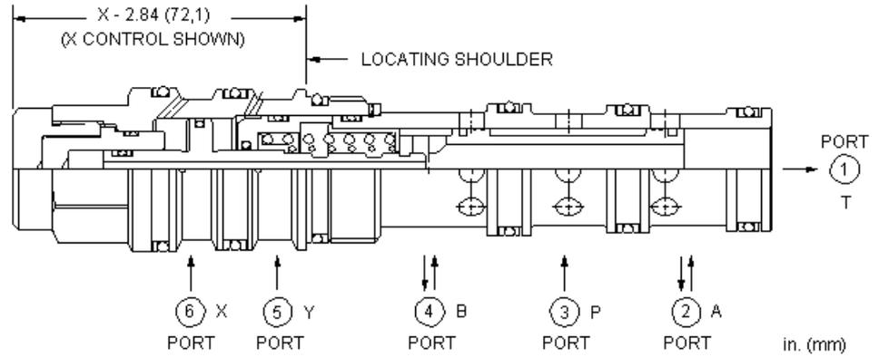
Les distributeurs en cartouches à 4 voies et 3 positions, centrés par des ressorts, sont des valves directionnelles à 6 orifices, qui offrent un choix de différentes configurations de tiroir. L'orifice d'alimentation est l'orifice 3 et tous les orifices acceptent 350 bar (5000 psi). La capacité en débit de ces valves à commutation par pilotage hydraulique dépend du type de tiroir choisi.
