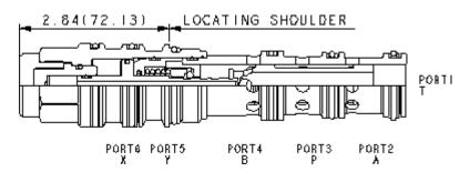
4/2-Wegeventil, hydraulisch betätigt, mit Raste und 6 Anschlüssen. 3 unterschiedliche Schieberversionen stehen zur Auswahl. Der Zulauf ist an Anschluss 3. Alle Anschlüsse können mit 350 bar belastet werden. Die maximale Durchflussmenge ist abhängig von der gewählten Schieberversion.
