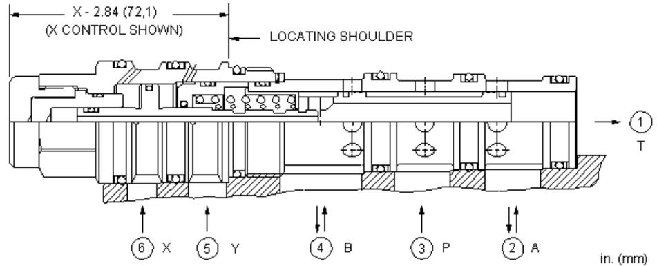
Les distributeurs en cartouches à 4 voies et 2 positions sont des valves directionnelles à 6 orifices qui offrent un choix de 9 configurations différentes de tiroir. L'orifice d'alimentation est l'orifice 3 et tous les orifices acceptent une pression de 350 bar (5000 psi). La capacité en débit de ces valves à commutation par pilotage hydraulique dépend du type de tiroir choisi.
