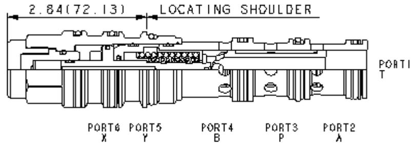
4/2-Wegeventil, hydraulisch betätigt, Federrückstellung, mit 6 Anschlüssen. 9 unterschiedliche Schieberversionen stehen zur Auswahl. Der Zulauf ist an Anschluss 3. Alle Anschlüsse können mit 350 bar belastet werden. Die maximale Durchflussmenge ist abhängig von der gewählten Schieberversion.
