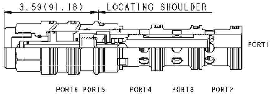
4/2-Wegeventil, hydraulisch betätigt, mit Raste und 6 Anschlüssen. 3 unterschiedliche Schieberversionen stehen zur Auswahl. Der Zulauf ist an Anschluss 3. Alle Anschlüsse können mit 350 bar belastet werden. Die maximale Durchflussmenge ist abhängig von der gewählten Schieberversion.
