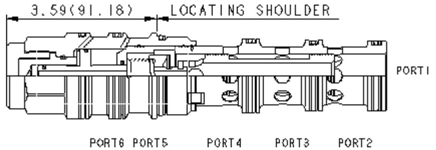
Les distributeurs en cartouches à 4 voies et 2 positions indexées sont des valves directionnelles à 6 orifices qui offrent un choix de 3 configurations différentes de tiroir. L'orifice d'alimentation est l'orifice 3 et tous les orifices acceptent une pression de 350 bar. La capacité en débit de ces valves à commutation par pilotage hydraulique dépend du type de tiroir choisi.
