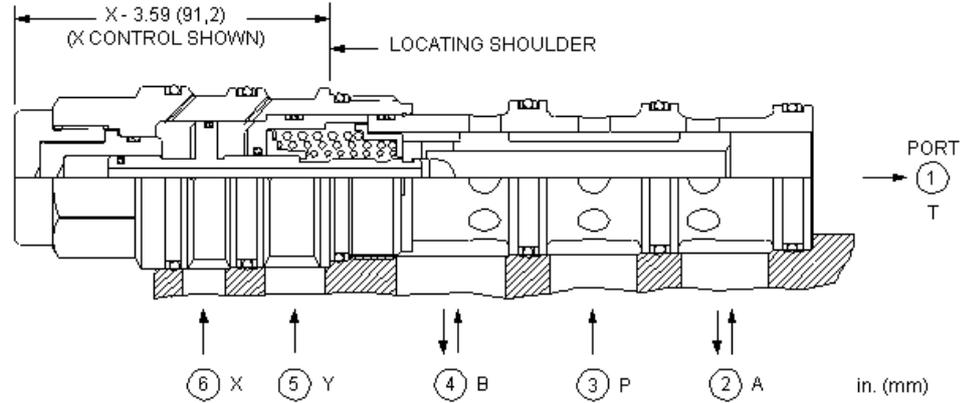
4/2-Wegeventil, hydraulisch betätigt, Federrückstellung, mit 6 Anschlüssen. 9 unterschiedliche Schieberversionen stehen zur Auswahl. Der Zulauf ist an Anschluss 3. Alle Anschlüsse können mit 350 bar belastet werden. Die maximale Durchflussmenge ist abhängig von der gewählten Schieberversion.
