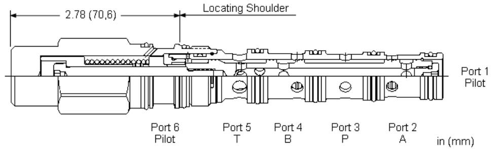
Les distributeurs en cartouches à 4 voies et 3 positions, centrés par des ressorts, sont des valves directionnelles à 6 orifices, qui offrent un choix de différentes configurations de tiroir. L'orifice d'alimentation est l'orifice 3 et tous les orifices acceptent 350 bar (5000 psi). La capacité en débit de ces valves à commutation par pilotage hydraulique dépend du type de tiroir choisi.
