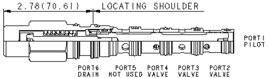
Les distributeurs en cartouches à 3 voies et 2 positions sont des valves directionnelles à 6 orifices (l'orifice 5 n'est pas utilisé) qui offrent un choix de 5 configurations différentes de tiroir. L'orifice d'alimentation est l'orifice 3 et tous les orifices acceptent une pression de 350 bar (5000 psi). La capacité en débit de ces valves à commutation par pilotage hydraulique dépend du type de tiroir choisi.
