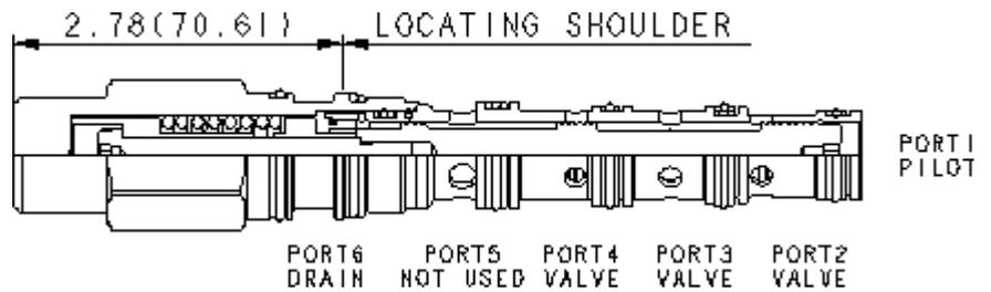
3/2-Wegeventile mit 6 Anschlüssen (Anschluss 5 nicht benutzt) sind mit 5 verschiedenen Schiebern erhältlich. Der Versorgungsanschluss ist Anschluss 3 und alle Anschlüsse sind für 350 bar ausgelegt. Der Nenndurchfluss dieser druckbetätigten Ventile ist schieberabhängig.
