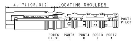
4/3-Wegeventil, hydraulisch betätigt, federzentriert, mit 6 Anschlüssen. Die Konfiguration hängt von der Wahl der Schieberversion ab. Der Zulauf ist an Anschluss 3. Alle Anschlüsse können mit 350 bar belastet werden. Die maximale Durchflussmenge ist abhängig von der gewählten Schieberversion.
