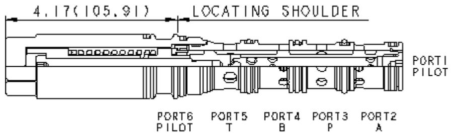
4/3-Wegeventil, hydraulisch betätigt, federzentriert, mit 6 Anschlüssen. Die Konfiguration hängt von der Wahl der Schieberversion ab. Der Zulauf ist an Anschluss 3. Alle Anschlüsse können mit 350 bar belastet werden. Die maximale Durchflussmenge ist abhängig von der gewählten Schieberversion.
