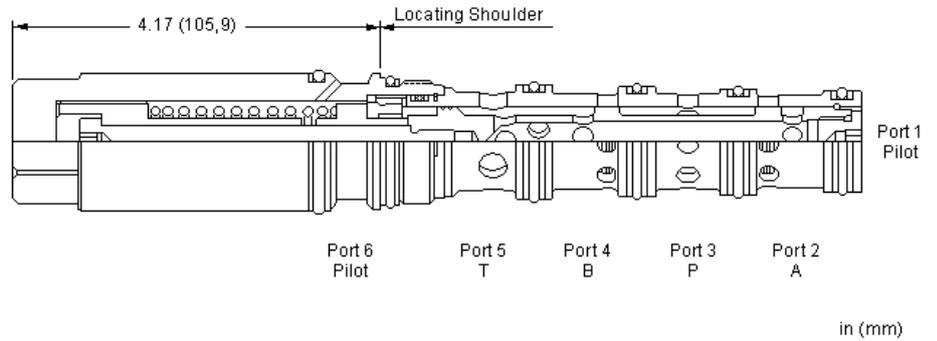
4/3-Wegeventil, hydraulisch betätigt, federzentriert, mit 6 Anschlüssen. Die Konfiguration hängt von der Wahl der Schieberversion ab. Der Zulauf ist an Anschluss 3. Alle Anschlüsse können mit 350 bar belastet werden. Die maximale Durchflussmenge ist abhängig von der gewählten Schieberversion.
