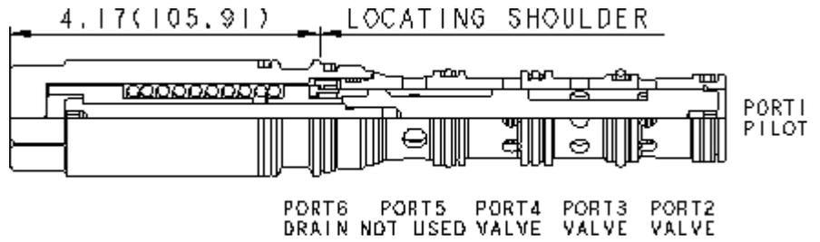
Les distributeurs en cartouches à 3 voies et 2 positions sont des valves directionnelles à 6 orifices (l'orifice 5 n'est pas utilisé) qui offrent un choix de 5 configurations différentes de tiroir. L'orifice d'alimentation est l'orifice 3 et tous les orifices acceptent une pression de 350 bar (5000 psi). La capacité en débit de ces valves à commutation par pilotage hydraulique dépend du type de tiroir choisi.
