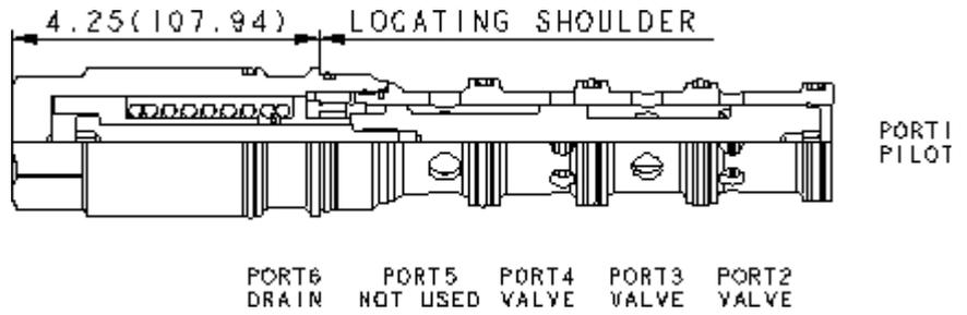
Les distributeurs en cartouches à 3 voies et 2 positions sont des valves directionnelles à 6 orifices (l'orifice 5 n'est pas utilisé) qui offrent un choix de 5 configurations différentes de tiroir. L'orifice d'alimentation est l'orifice 3 et tous les orifices acceptent une pression de 350 bar (5000 psi). La capacité en débit de ces valves à commutation par pilotage hydraulique dépend du type de tiroir choisi.
