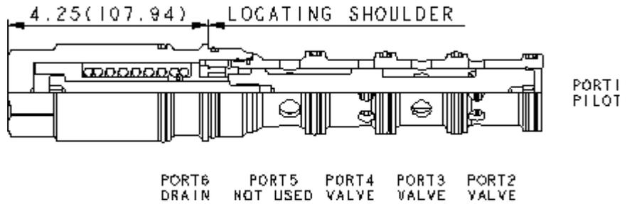
Les distributeurs en cartouches à 3 voies et 2 positions sont des valves directionnelles à 6 orifices (l'orifice 5 n'est pas utilisé) qui offrent un choix de 5 configurations différentes de tiroir. L'orifice d'alimentation est l'orifice 3 et tous les orifices acceptent une pression de 350 bar (5000 psi). La capacité en débit de ces valves à commutation par pilotage hydraulique dépend du type de tiroir choisi.
