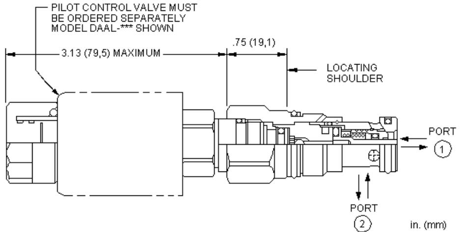
2/2-Wege Sitzventil (Hauptstufe) für T-8A Vorsteuerventil. Das Ventil steuert den Durchfluss von Anschluss 2 nach 1. Die Leckage ist extrem gering. Alle Anschlüsse können mit 350 bar belastet werden. Der Einbau eines magnetbetätigten Vorsteuerventils in die T-8A Einschraubbohrung ergibt ein zweistufiges Wegeventil mit hoher Durchflussleistung. Vorsteuerventile mit manueller, hydraulischer oder pneumatischer Betätigung aus der gleichen Pilotventilserie stehen zur Verfügung.
