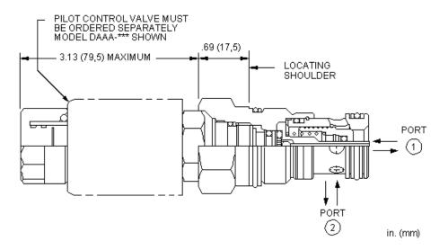
2/2-Wege Sitzventil (Hauptstufe) für T-8A Vorsteuerventil. Das Ventil steuert den Durchfluss von Anschluss 2 nach 1. Die Leckage ist extrem gering. Alle Anschlüsse können mit 350 bar belastet werden. Der Einbau eines magnetbetätigten Vorsteuerventils in die T-8A Einschraubbohrung ergibt ein zweistufiges Wegeventil mit hoher Durchflussleistung. Vorsteuerventile mit manueller, hydraulischer oder pneumatischer Betätigung aus der gleichen Pilotventilserie stehen zur Verfügung.
