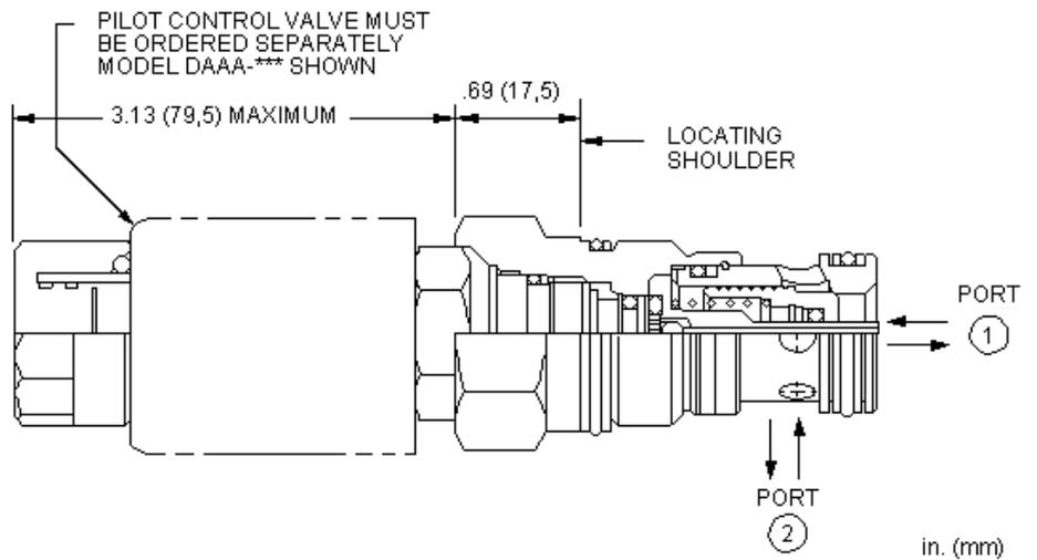
Cette valve est une cartouche 2 voies /2 positions à clapet qui intègre une cavité destinée à une valve de pilotage. Elle contrôle le débit depuis l'orifice 2 vers l'orifice 1, affiche des taux de fuite extrêmement bas et accepte 350 bar (5000 psi) sur ses 2 orifices. En installant une électrovalve de pilotage dans sa cavité T-8A on obtient un distributeur de grande capacité. Les valves de pilotage existent également avec des commandes manuelles, hydrauliques et pneumatiques.
