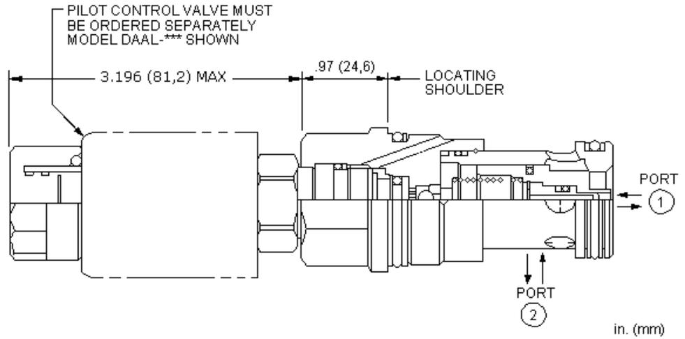
2/2-Wege Sitzventil (Hauptstufe) für T-8A Vorsteuerventil. Das Ventil steuert den Durchfluss von Anschluss 1 nach 2. Die Leckage ist extrem gering. Alle Anschlüsse können mit 350 bar belastet werden. Der Einbau eines magnetbetätigten Vorsteuerventils in die T-8A Einschraubbohrung ergibt ein 2-stufiges Wegeventil mit hoher Durchflussleistung. Vorsteuerventile mit manueller, hydraulischer oder pneumatischer Betätigung aus der gleichen Pilotventilserie stehen zur Verfügung.
