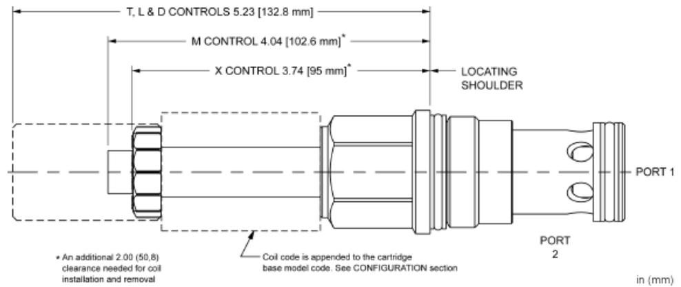
Diese magnetbetätigte 2/2-Wegeventil ist ein vorgesteuertes Wegeventil in Sitzbauweise mit Umgehungs Rückschlagventil. Die Ventile sind mit geschlossener oder geöffneter Ruhestellung erhältlich. Aufgrund der kegelförmigen Konstruktion ist die Leckage äußerst gering. Die Ventile werden mit Spulen der Serien 740 und 747 betrieben.
