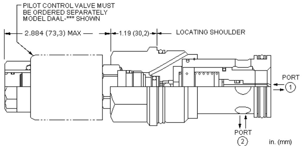
Cette valve est une cartouche 2 voies /2 positions à clapet qui intègre une cavité destinée à une valve de pilotage. Elle contrôle le débit depuis l'orifice 1 vers l'orifice 2, affiche des taux de fuite extrêmement bas et accepte 350 bar (5000 psi) sur ses 2 orifices. En installant une électrovalve de pilotage dans sa cavité T-8A on obtient un distributeur de grande capacité. Les autres options de pilotage comprennent des cartouches à commandes manuelles, hydrauliques et pneumatiques.
