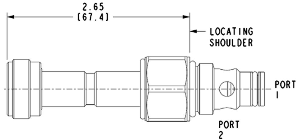
Das magnetbetätigte 2/2-Wegeventil ist ein vorgesteuertes Sitzventil. Das 2/2-Wegeventil hat einen geringen Druckverlust als vergleichbare direktgesteuerte Wegeventile. Das Ventil ist in Ruhestellung geöffnet und geschlossen erhältlich.
