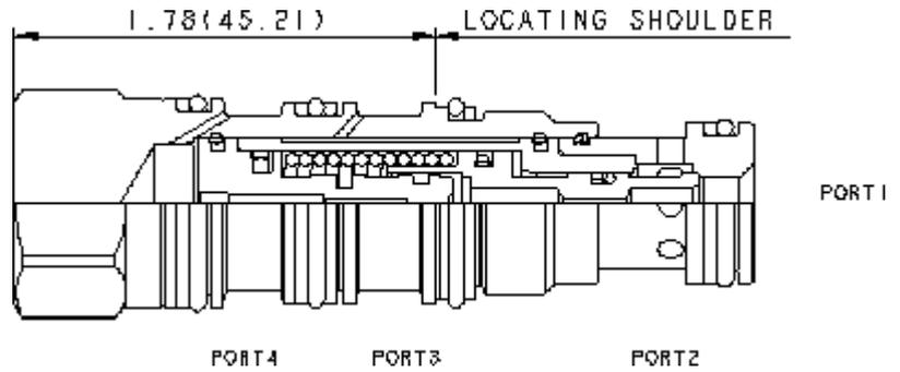
Les éléments logiques normalement fermés qui commutent quand on libère le drain sont des valves à clapet hydrauliquement équilibrées entre les chambres 1 et 2. Le ressort principal maintient la valve fermée. Quand une pression de pilotage est appliquée alors que le drain est bloqué (chambre 4) la valve reste dans la position fermée. Lorsque le drain est libéré, cela déséquilibre le clapet et la valve commute à la position ouverte.
