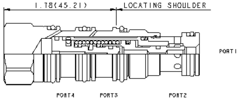
Dies ist ein in Ruhestellung geschlossenes Schaltelement in druckausgeglichener Sitzbauweise. Steuerdruck an Anschluss 3 schaltet das Ventil in die offene Stellung.
