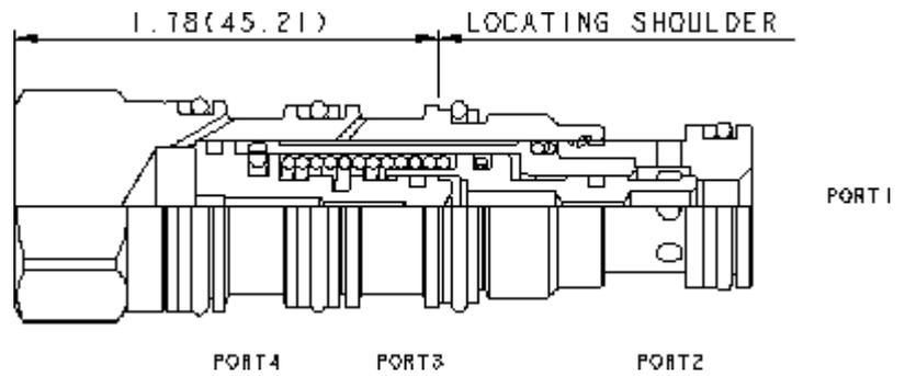
Les éléments logiques normalement fermés à action directe sont des valves à clapet hydrauliquement équilibrées entre les chambres 1 et 2. Le ressort principal maintient la valve fermée et lorsqu'une pression de pilotage est appliquée à la chambre 3 la valve commute à la position ouverte.
