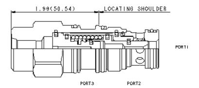
Dies ist ein in Ruhestellung geschlossenes Schaltelement in druckausgeglichener Sitzbauweise. Steuerdruck an Anschluss 3 schaltet das Ventil in die offene Stellung.
