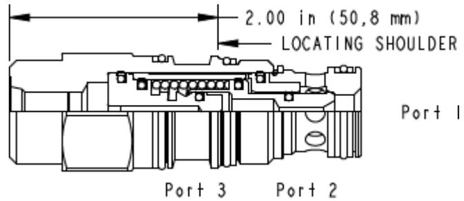
Dies ist ein in Ruhestellung geschlossenes Schaltelement in druckausgeglichener Sitzbauweise. Bei gesperrtem externen Entlastungsanschluss bleibt der Ventilkolben in der geschlossenen Stellung. Das Ventil öffnet, wenn der externe Anschluss entlastet wird und ausreichender Steuerdruck an Anschluss 3 anliegt.
