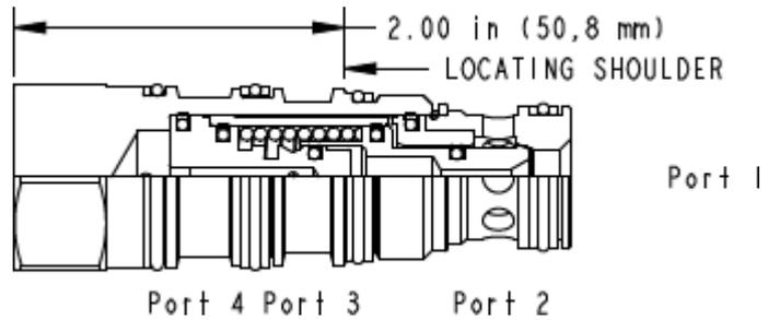
Dies ist ein in Ruhestellung geschlossenes Schaltelement in druckausgeglichener Sitzbauweise. Bei gesperrtem Entlastungsanschluss 4 bleibt der Kolben in der geschlossenen Stellung. Das Ventil öffnet, wenn Anschluss 4 entlastet wird und ausreichender Steuerdruck an Anschluss 3 anliegt.
