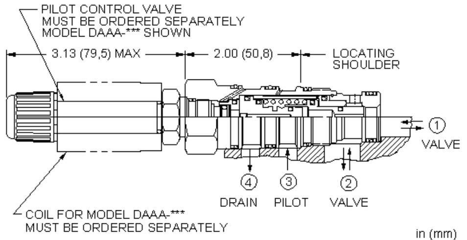
Dies ist ein in Ruhestellung geschlossenes Schaltelement in druckausgeglichener Sitzbauweise mit integrierter T-8A Einschraubbohrung. Wird in die T-8A-Bohrung ein 2/2-Wegeventil in gesperrter Stellung installiert, so bleibt der Ventilkolben geschlossen. Eine Öffnung des Wegeventils und ausreichender Steuerdruck an Anschluss 3 bewirken, dass der Kolben in die offene Ventilstellung geschaltet wird.
