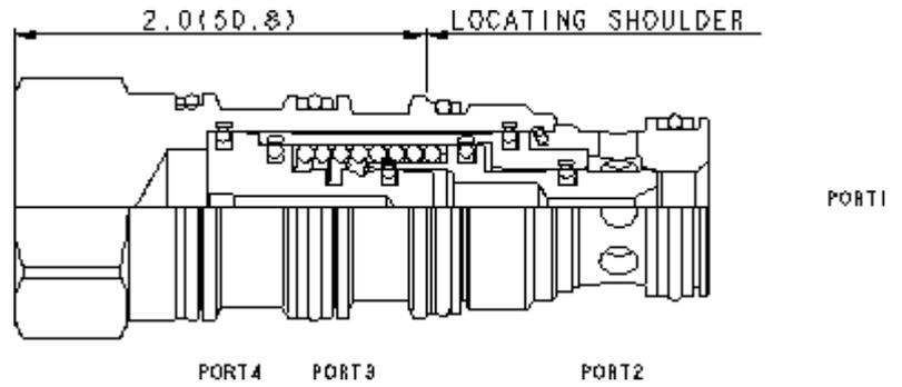
Dies ist ein in Ruhestellung geschlossenes Schaltelement in druckausgeglichener Sitzbauweise. Steuerdruck an Anschluss 3 schaltet das Ventil in die offene Stellung.
