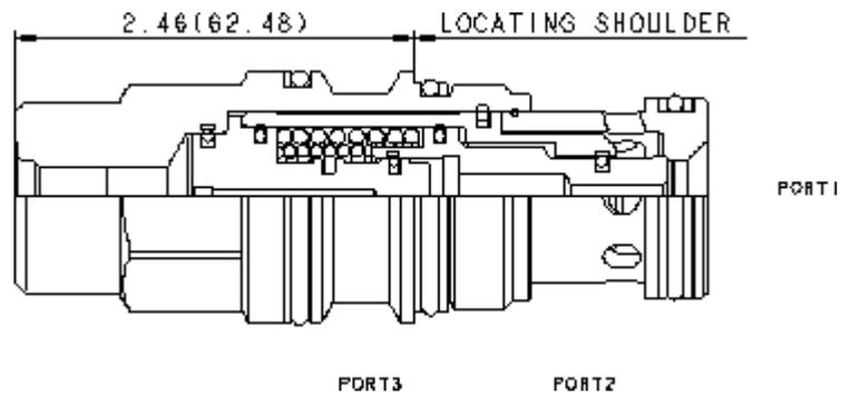
Dies ist ein in Ruhestellung geschlossenes Schaltelement in druckausgeglichener Sitzbauweise. Steuerdruck an Anschluss 3 schaltet das Ventil in die offene Stellung.
