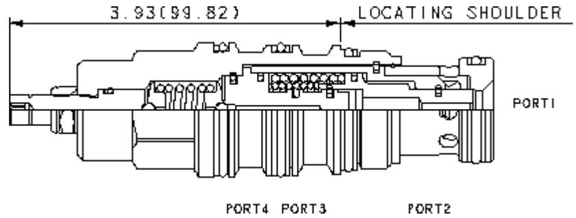
Dies ist ein in Ruhestellung geschlossenes Schaltelement in druckausgeglichener Sitzbauweise. Bei Steuerdruck an Anschluss 3 bleibt das Ventil zunächst gesperrt. Übersteigt der Steuerdruck den Einstellwert der internen Druckbegrenzung, so schaltet das Ventil in die offene Stellung.
