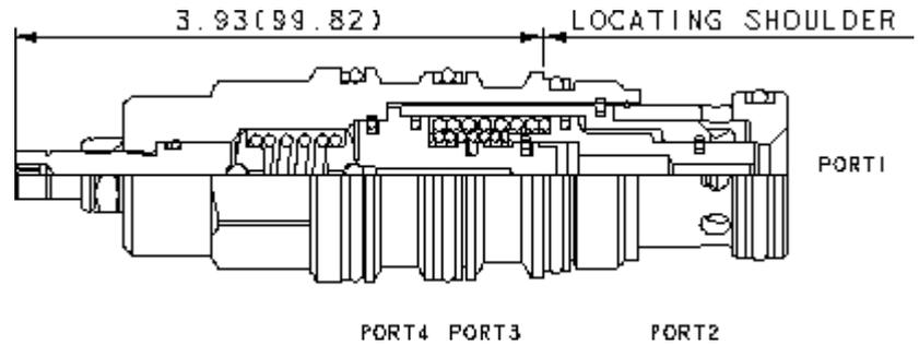
Dies ist ein in Ruhestellung geschlossenes Schaltelement in druckausgeglichener Sitzbauweise. Bei Steuerdruck an Anschluss 3 bleibt das Ventil zunächst gesperrt. Übersteigt der Steuerdruck den Einstellwert der internen Druckbegrenzung, so schaltet das Ventil in die offene Stellung.
