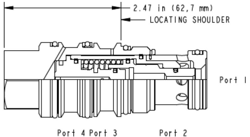
Les éléments logiques normalement fermés qui commutent quand on libère le drain sont des valves à clapet hydrauliquement équilibrées entre les chambres 1 et 2. Le ressort principal maintient la valve fermée. Quand une pression de pilotage est appliquée alors que le drain est bloqué (chambre 4) la valve reste dans la position fermée. Lorsque le drain est libéré, cela déséquilibre le clapet et la valve commute à la position ouverte.
