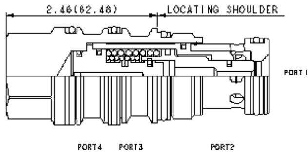
Dies ist ein in Ruhestellung geschlossenes Schaltelement in druckausgeglichener Sitzbauweise. Steuerdruck an Anschluss 3 schaltet das Ventil in die offene Stellung.
