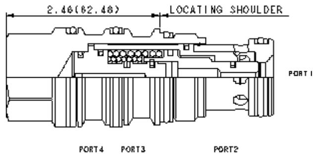
Les éléments logiques normalement fermés à action directe sont des valves à clapet hydrauliquement équilibrées entre les chambres 1 et 2. Le ressort principal maintient la valve fermée et lorsqu'une pression de pilotage est appliquée à la chambre 3 la valve commute à la position ouverte.
