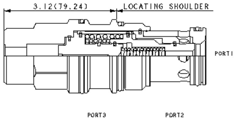
Les éléments logiques à 3 chambres, normalement fermés, à action directe, sont des valves à clapet hydrauliquement équilibrées entre les chambres 1 et 2. Le ressort principal maintient la valve fermée et lorsqu'une pression de pilotage est appliquée à la chambre 3 la valve commute à la position ouverte.
