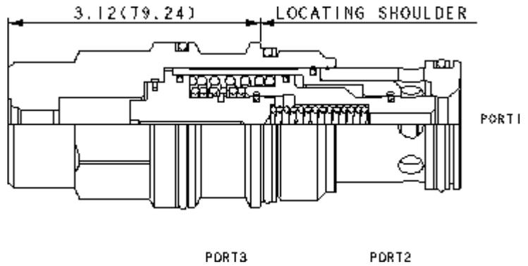
Les éléments logiques à 3 chambres, normalement fermés, qui commutent quand on libère le drain sont des valves à clapet hydrauliquement équilibrées entre les chambres 1 et 2. Le ressort principal maintient la valve fermée et lorsqu'une pression de pilotage est appliquée alors que l'orifice externe du drain est bloqué, la valve reste fermée. Lorsque l'orifice externe du drain est libéré, cela déséquilibre le clapet et la valve commute à la position ouverte.
