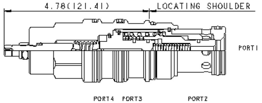
Les éléments logiques normalement fermés qui commutent quand on les pilote et dont la pression pilote est réglable sont des valves à clapet hydrauliquement équilibrées entre les chambres 1 et 2. Le ressort principal maintient la valve fermée jusqu'à ce que la pression pilote, qui est réglée sur l'étage pilote intégré et appliquée à l'orifice 3, soit atteinte. A cet instant la valve commute à la position ouverte.
