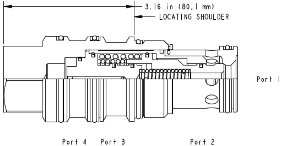
Dies ist ein in Ruhestellung geschlossenes Schaltelement in druckausgeglichener Sitzbauweise. Bei gesperrtem Entlastungsanschluss 4 bleibt der Kolben in der geschlossenen Stellung. Das Ventil öffnet, wenn Anschluss 4 entlastet wird und ausreichender Steuerdruck an Anschluss 3 anliegt.
