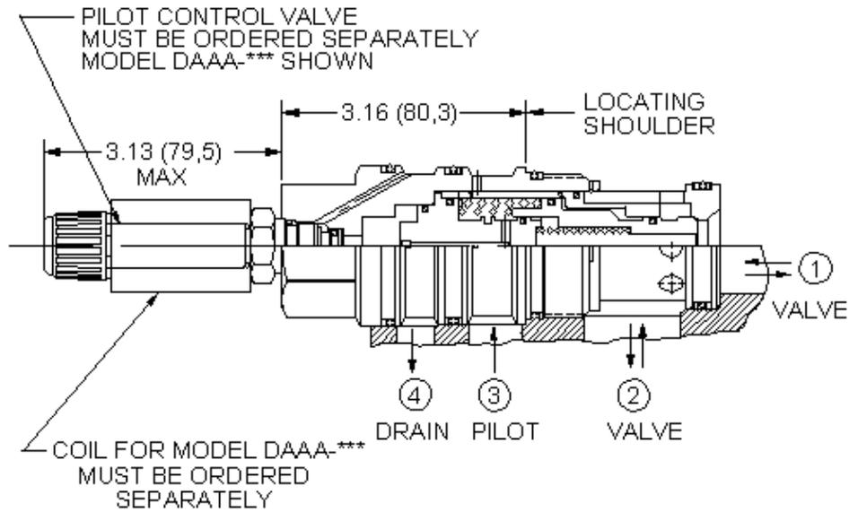
Dies ist ein in Ruhestellung geschlossenes Schaltelement in druckausgeglichener Sitzbauweise mit integrierter T-8A Einschraubbohrung. Wird in die T-8A-Bohrung ein 2/2-Wegeventil in gesperrter Stellung installiert, so bleibt der Ventilkolben geschlossen. Eine Öffnung des Wegeventils und ausreichender Steuerdruck an Anschluss 3 bewirken, dass der Kolben in die offene Ventilstellung geschaltet wird.
